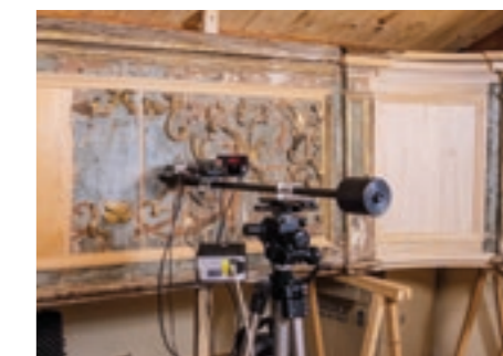
Spettrofotometria XRF e spettroscopia ad infrarossi in trasformata di Fourier
