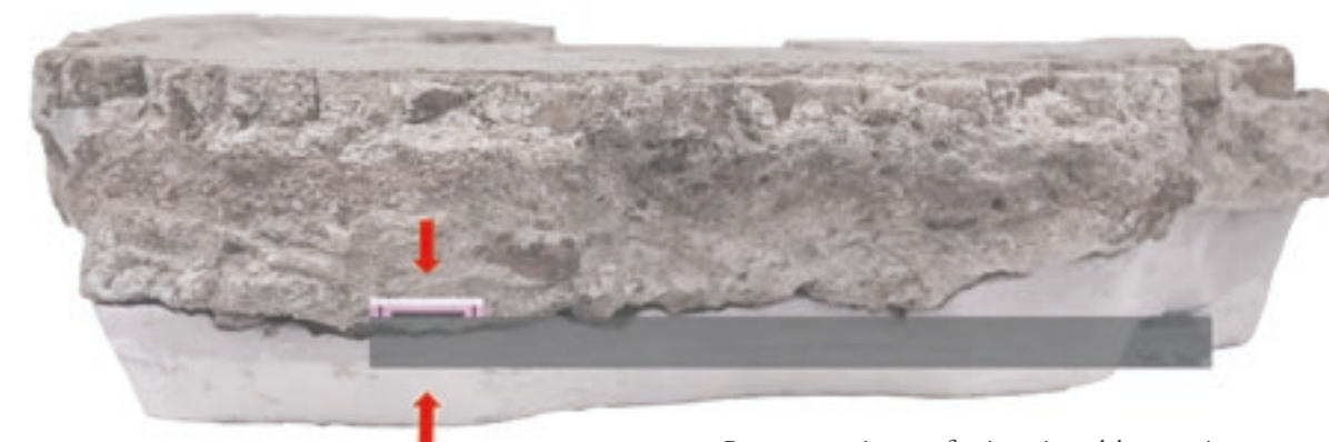
Rappresentazione grafica in sezione del meccanismo del sistema di ancoraggio magnetico
