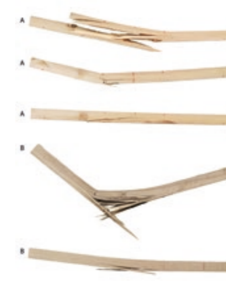
I campioni di larice (A) e rovere (B) durante la sperimentazione
