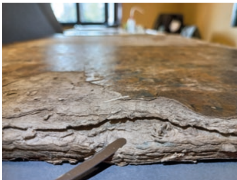
Condizione di degrado dei cartoni prima del restauro: delaminazioni, lacune e lacerazioni degli strati di composizione dei quadranti
