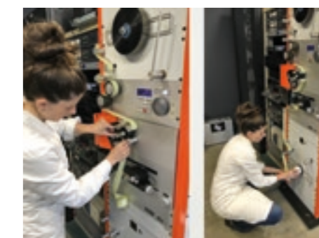
Posizionamento della pellicola all'interno della Sondor Altra 2K
