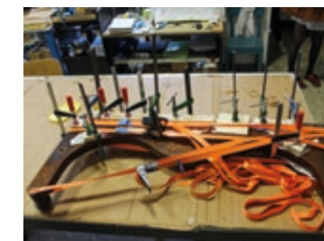
Incollaggio delle lastronature e degli incastri per mezzo di morsetti e tiranti.
