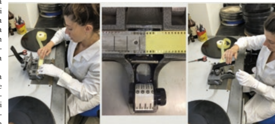
Ripristino di una giunta tramite l'ausilio della Pressa Catozzo
